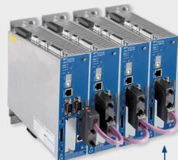
Im Vollausbau 4 Servopositionerregler ARS 2000 – verbunden über CANopen DSP402 mit MC 2000 im Master Servopositionerregler.
