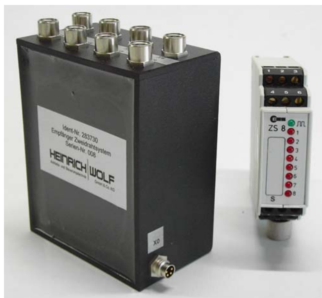
Abbildung: Empfänger im Vergussgehäuse (links), Sender (rechts)
