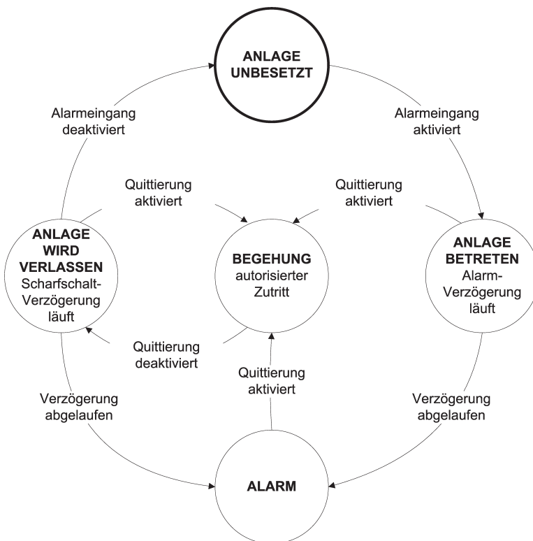
Zustandsdiagramm der Objektschutzfunktion
