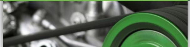
Der Optidrive Eco HLK gibt bei einem Riemenbruch zwischen Motor und Lüfter Sofort-Warnmeldungen aus. Durch ihre einfache und flexible Konfiguration kann diese Funktion ebenfalls bei Lastverlusten, wie einer ausgerückten Kupplung oder anderen mechanischen Fehlern, genutzt werden.
