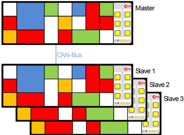
**EES** Die Parametrierung kaskadierter Störmelder erfolgt vollumfänglich nur im „Master-Störmelder“ und wird dann automatisch an die „Slave-Störmelder“ verteilt.
